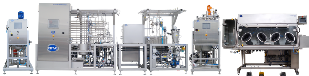
100L/h Mistura + HTST/UHT indireto + Tubos de retenção + UHT direto, Amortecimento asséptico, Envase asséptico
