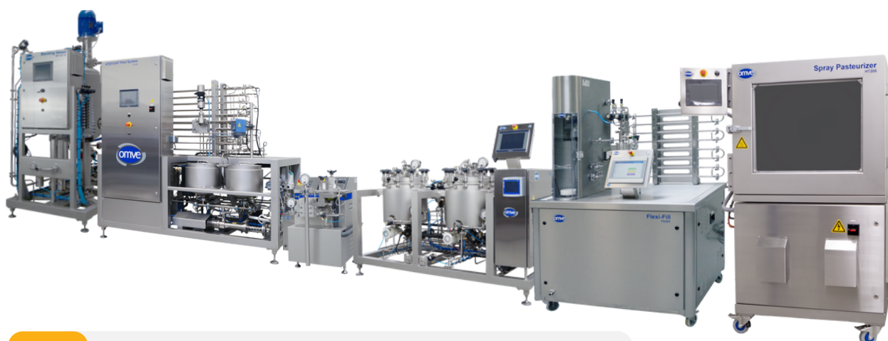
50-100L/h Mistura + HTST/UHT + Homogeneização + Carbonatação + Envase + Pasteurização na embalagem
