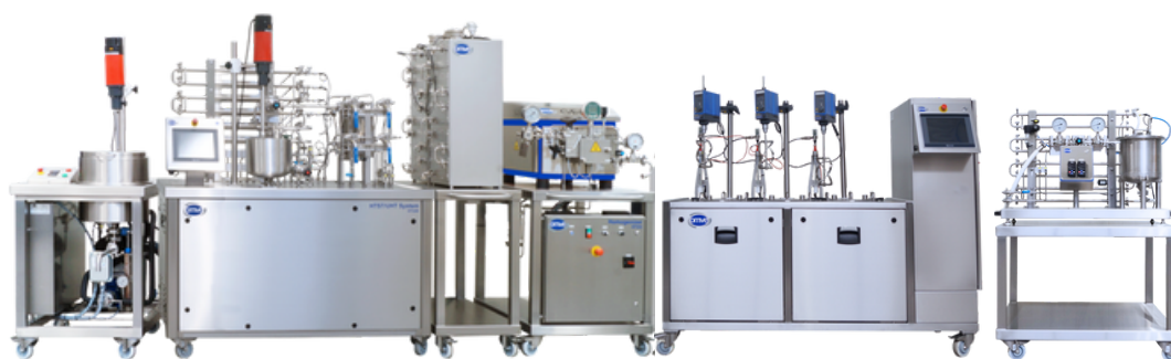
30L/h Mezclado + Sistema HTST/UHT Indirecto + Tubos sostenimiento + Homogenización + Fermentación + Texturizador
