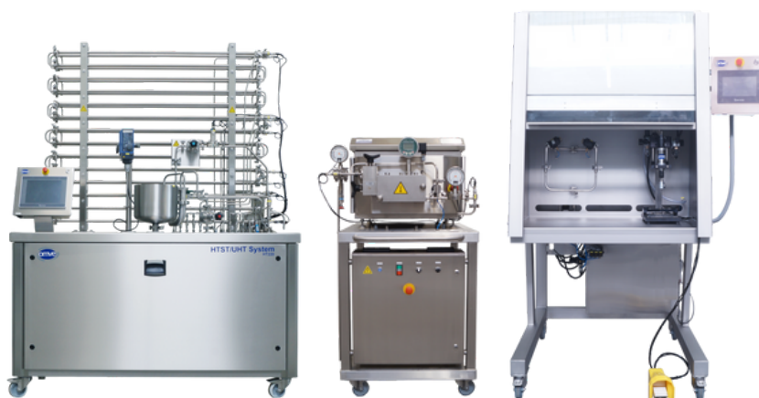
Homogeneizador integrado, operado a través de la HMI del sistema UHT
