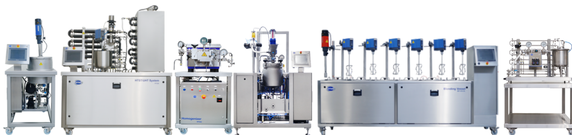
30L/h Mezclado + HTST/UHT + Homogenización + Fermentación + Texturización
