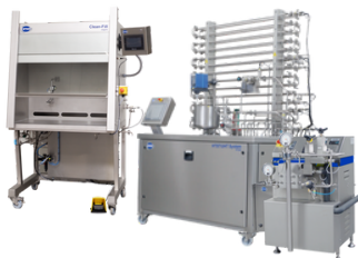
50L/h HTST/UHT + Homogenización + Llenado
