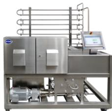
Mistura de alta cisalha, industrial e com controle de temperatura
