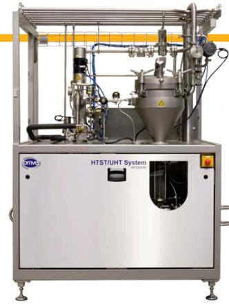
OMVE ha diseñado un sistema DSI completamente sanitario con tanque de enfriamiento rápido que ofrece un alto nivel de automatización para que su operación sea muy fácil de usar. Esta unidad puede integrarse en un sistema UHT existente.
