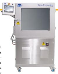
Las boquillas en la cámara rocían agua de manera uniforme sobre los envases en las cajas. Con un control de temperatura altamente preciso mediante sondas de temperatura en el producto y un tratamiento térmico uniforme, la sobrepasteurización del producto se reduce al mínimo.
