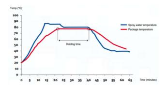
No diagrama, é mostrado um exemplo das temperaturas dentro da garrafa comparadas com a temperatura da água pulverizada. É possível configurar a temperatura e o tempo de superaquecimento.
